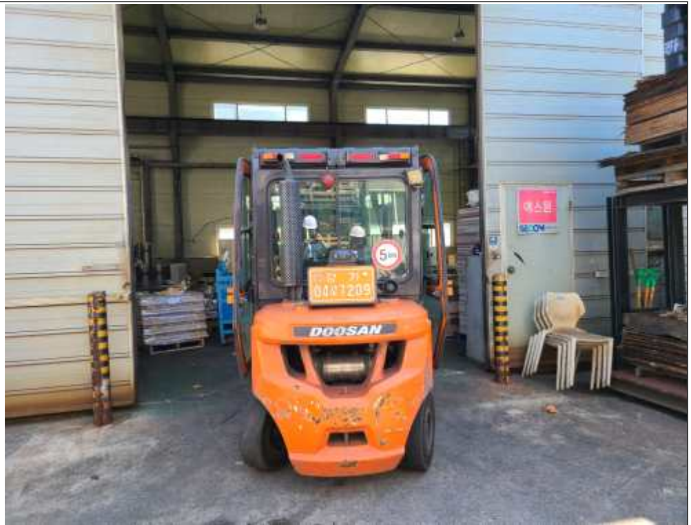
지게차 후진경보음, 경광등 미 작동 상 태로 운행
